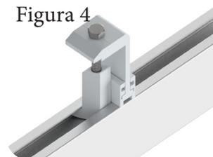
Para montagem dos grampos, inserir a parte inferior do grampo (figura 1), girar (figura 2), até ele ficar preso (figura 3), depois colocar a parte superior do grampo (figura 4).
